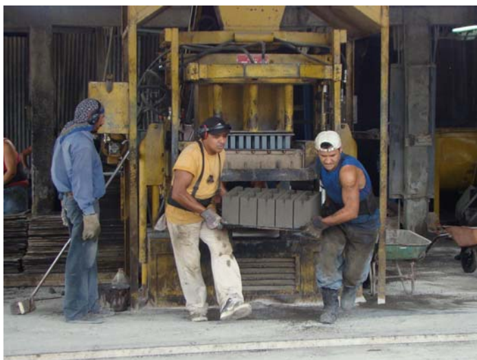
Elaboración de blocks. Centro Penal La Reforma
